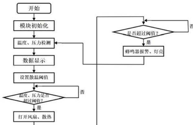
当电池的环境温度或所受压力超过预设的阈值时, 会触发预警系统发出警报。通过面包板上的三个独立按键设置温度、压力的阈值: KEY1控制阈值减, KEY2控制温度阈值加, KEY3解除警报的。根据温度的等级不同触发警报, 蜂鸣器每隔预设时间响/停一次。
