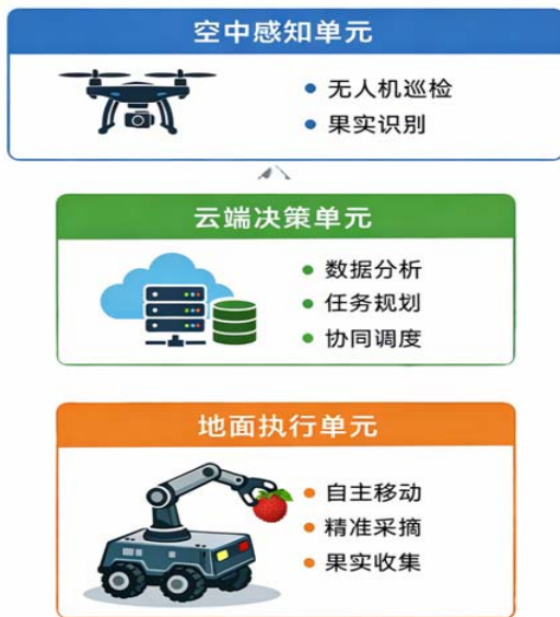
图1 智能采摘系统结构图
