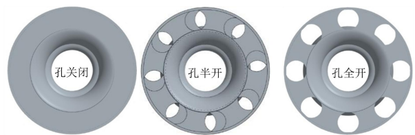
图 11 文氏管调压孔的三种状态
