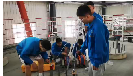
图5 学生在桥梁综合实训基地进行桩基超声波检测实操
