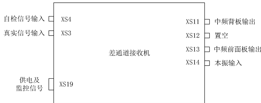
图 3-1 差通道接收机各接口信号示意图
