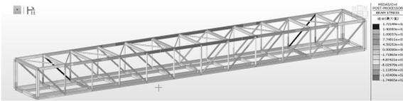
图 3 通廊式结构 36m 跨计算模型云图
