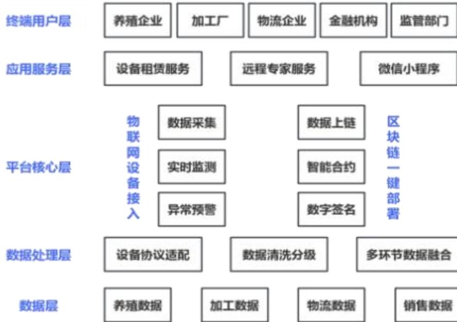
图1 “区块链+物联网”技术集成平台
