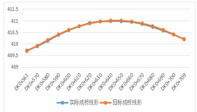
图4 成桥主梁线形
