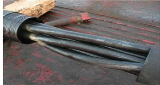
第五次组下铣鞋+套铣筒内带开窗捞筒进行打捞, 发现Φ146mm铣鞋倒扣落井, 内装的Φ125mm的开窗捞筒一起落井。
