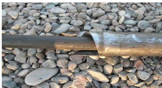
(2)套管内打捞。下Φ114mm抽油杆打捞筒(打捞范围: Φ28mm-45mm)打捞2次;
