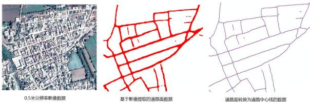
图 2 道路中心线提取流程示例
