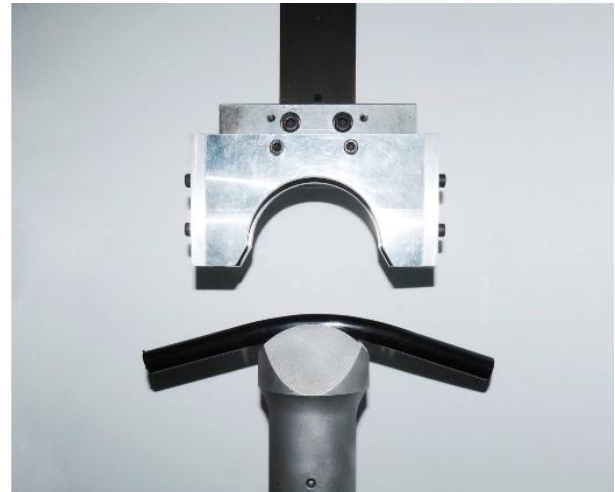
图5 超声辅助波管成型
