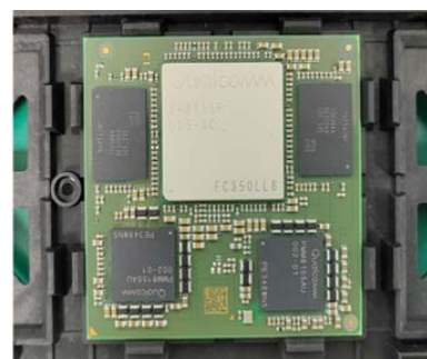
图4 某SIP模组的结构示例,可辅助理解设计相关策略对其可靠性和安全性的影响
