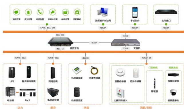
图2 动环监控系统的告警方式示意图
