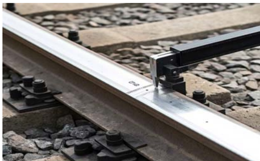
轨道道岔密贴检测技术示意图
