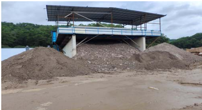
图2-1 盾构渣土泥水分离后挤压泥饼
