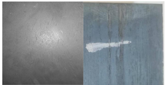
图1 管线钢L555M红送裂纹(左)和铸坯纵裂衍生裂纹(右)宏观样貌
