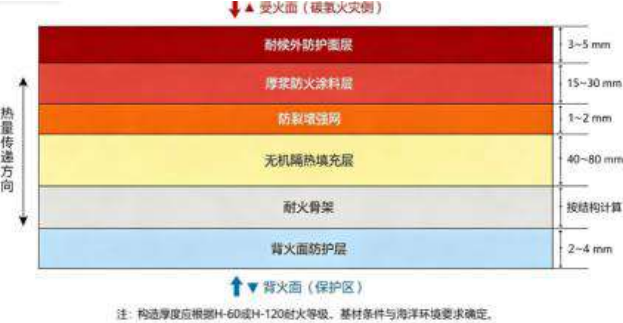
图1 H级防火分隔复合构造剖面示意图
