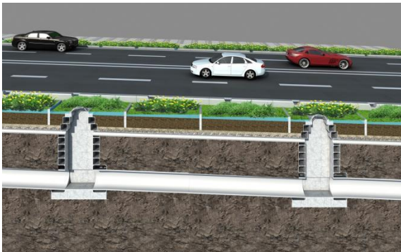
图8 纵断面示意图
