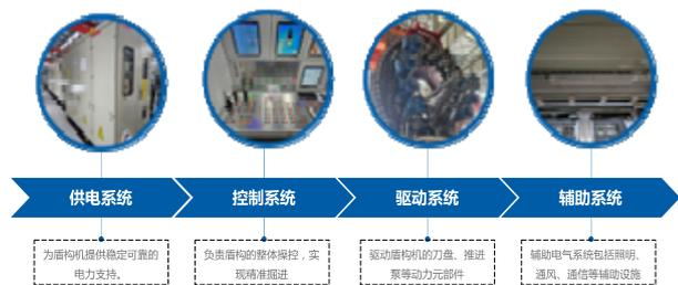
图1.1 盾构机电气系统组成
