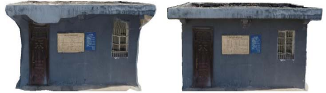
图6 初始构建模型的侧面数据与精细化模型侧面对比图
