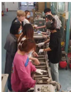
图1 小组成员紧密配合完成矿物改性PP的共混挤出造粒
