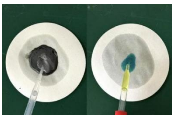
图5 验证铁的吸氧腐蚀负极产物的改进实验
