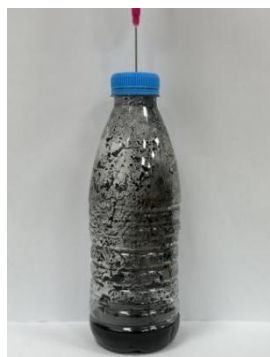
图6 强酸环境下金属腐蚀的实验探究
