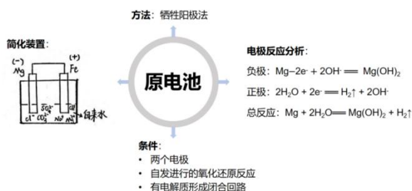
图9 镁棒防腐设计模型
