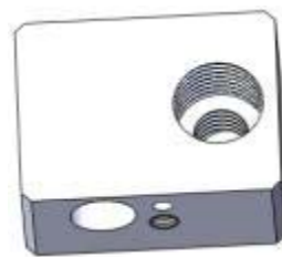
图2.2 加热铝块外形三维模型
