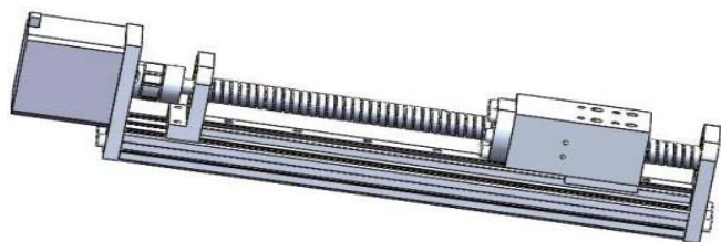
图4.1 FSL40-200直线模组三维模型图
