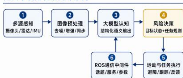
图1 无人车认知决策闭环架构
