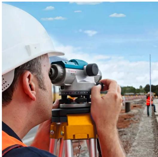
图一 使用DS3自动水准仪进行高程测量
