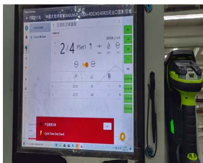
图4-2-2 EP系统紧固件防错
