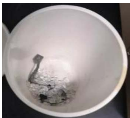
c. 光伏组件450℃热解样
