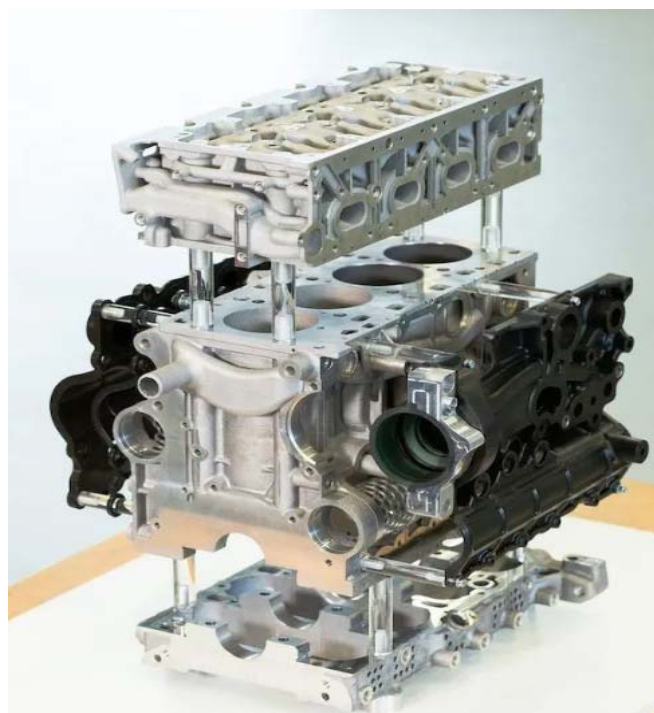
图1 采用3D打印集成制造汽车发动机部件
