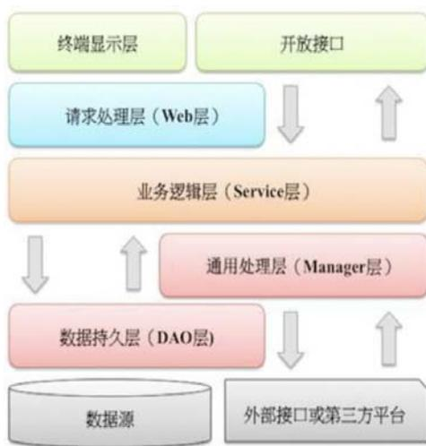
图1 逻辑模型结构图
