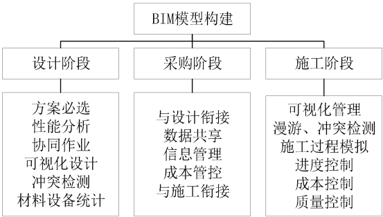
图 1 BIM 技术在 EPC 项目的应用
