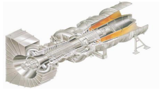
图3 M701DA 燃气轮机剖面图
