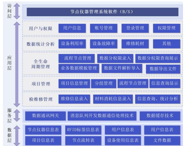
图 3 节点仪器管理软件架构设计图
