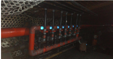
图 2 (3#高位钻场优化抽采系统布置图)
