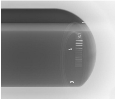
图1 PE焊接接头DR成像
