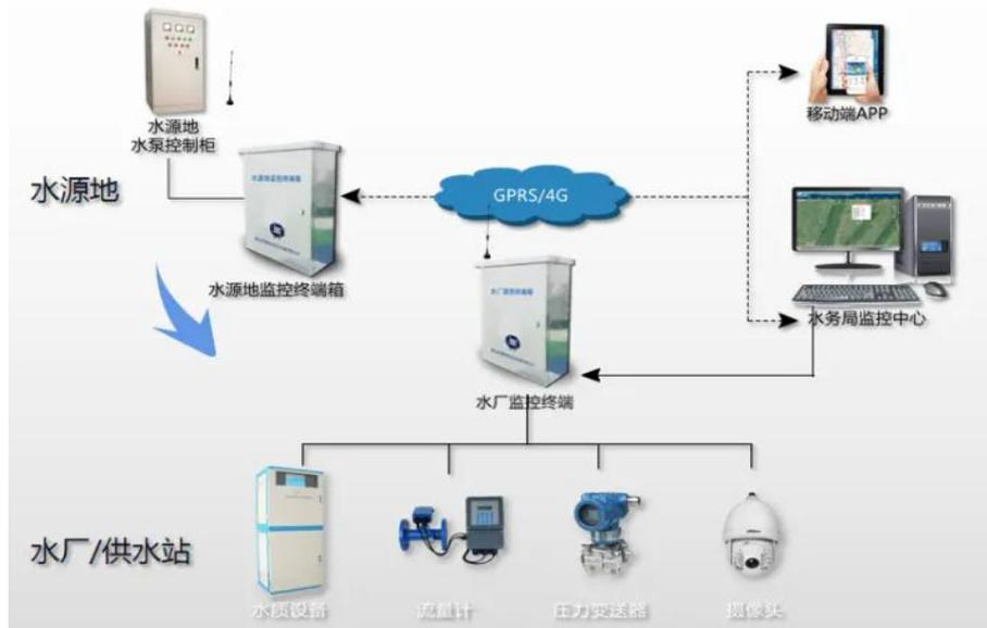
图 2 该水厂自动化检测系统
