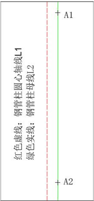
钢管柱竖向侧面图
