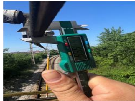
图 5 测量接触线磨损
