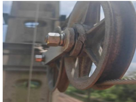
图 7 轮轴断裂的下锚装置
