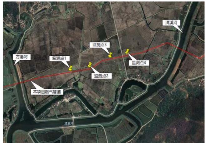
图2 管道监测点布置图
