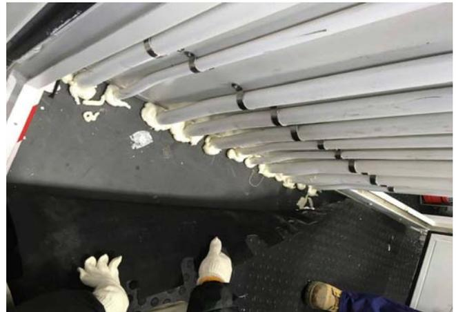
图3 电气房电气管穿越底架发泡剂封堵
