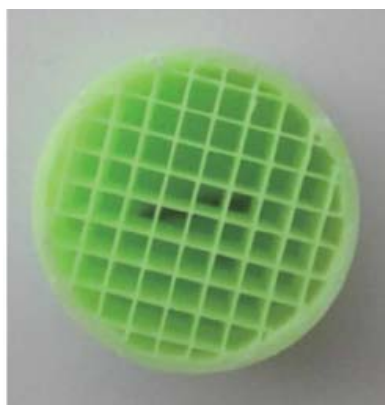
图6 3D打印材料内部结构
