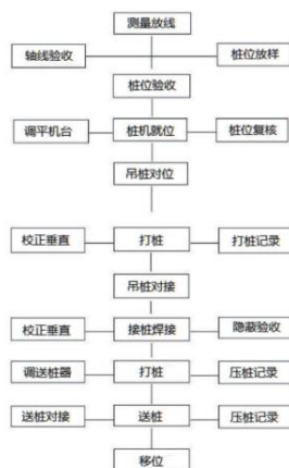
图1 静力压桩施工流程
