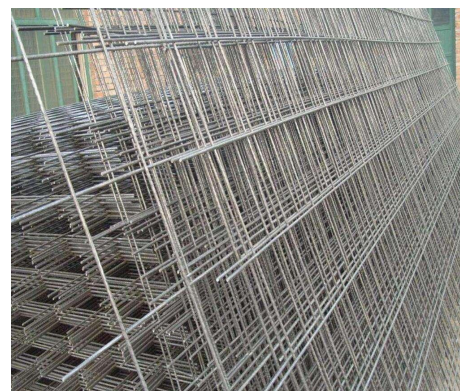
图1 加固钢筋网片
