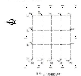
立柱编号为轴线交叉组合编号;  $\Delta N$  为平行轴线近似北方向,数据为正表示顶部相对于底部向北偏,数据为负表示顶部相对于底部向南偏;  $\Delta E$  为近似东方向,与  $\Delta N$  方向垂直; 数据为正表示顶部相对于底部向东偏,数据为负表示顶部相对于底部向西偏。
