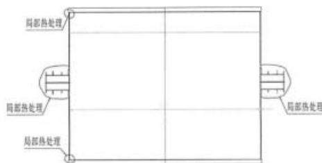
图4 筒体与管板的角焊缝
