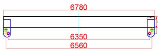
图3 大钩横梁双孔中心尺寸设计 (原设计6560mm)
