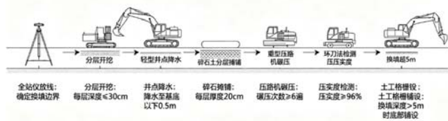
图1 换填改良技术及施工工艺要点
