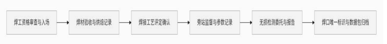
图2 焊接质量数据溯源流程图
