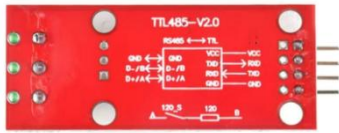
图2 TTL 转 RS-485 模块
