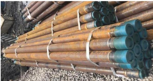
图2 Φ127mm-103\*3000mm 套铣钻杆
