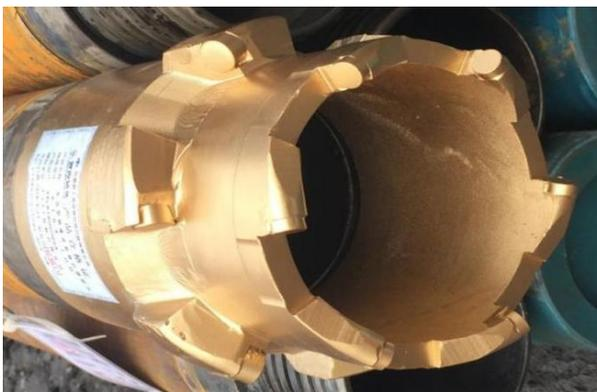
图3 Φ168/100mm 套铣钻头
