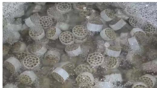
图8 流化床载体(聚乙烯中空圆柱体)
