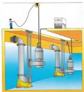
图4 自耦式潜水排污泵原理图
